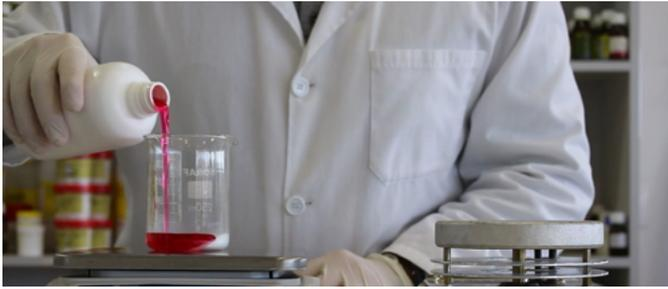
**Paso 1.** Pesar el bicarbonato y la solución Oral GUINAMA y disolver con agitador magnético hasta total incorporación.
